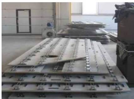
Изготовление панелей перекрытий по технологии VST
